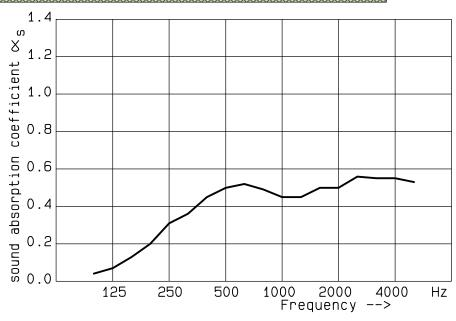
Averages of  $\propto_{\mathsf{S}}$ : 400 - 1250 Hz: 0.48 1600 - 5000 Hz: 0.53 125 - 4000 Hz: 0.41 100 - 5000 Hz: 0.40 100 - 315 Hz: 0.18 500 - 2000 Hz: 0.49 Evaluation acc. EN ISO 11'654 (1997):
